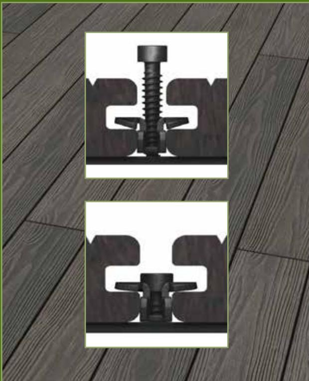
Die letzte Reihe wird genau wie die erste Reihe befestigt. Breitenzuschnitte von oben sichtbar verschrauben.
